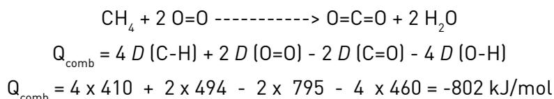
La réaction est donc exothermique, ce qui est normal pour une réaction de combustion !
