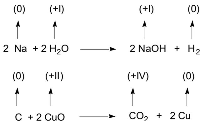
13. Il suffit de savoir que lorsque l'on considère 2 couples rédox, la seule réaction possible a lieu entre l'oxydant le plus fort et le réducteur le plus fort. Plus le potentiel standard est élevé, plus l'oxydant du couple est fort et vice-versa.
